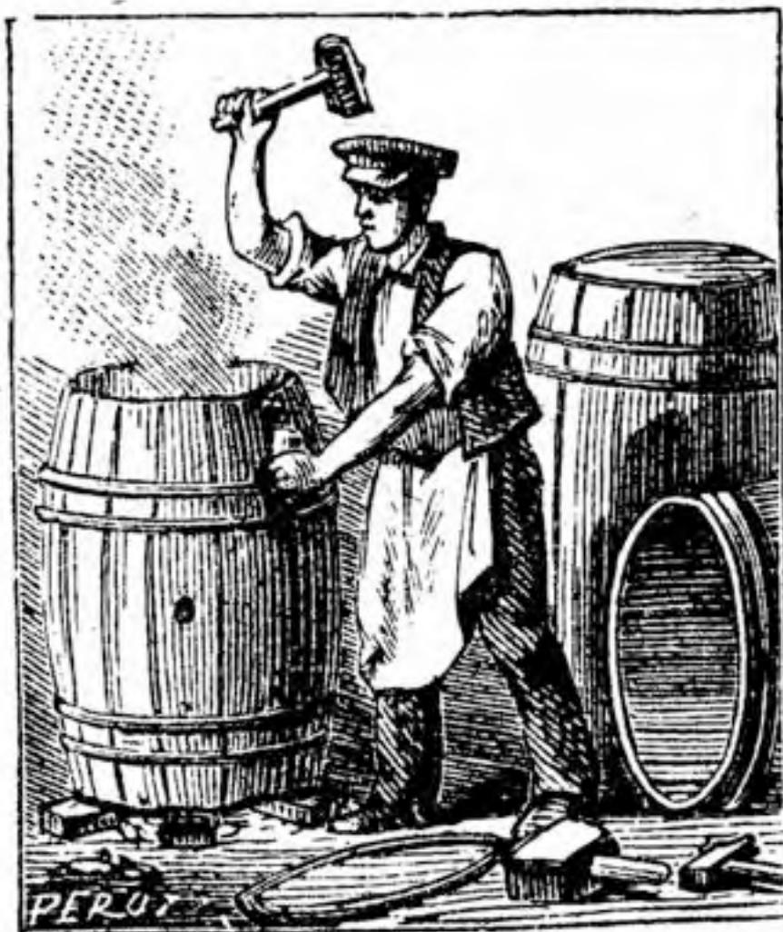
LE TONNELIER. — Pour rendre plus flexibles les douves qu'il veut recourber et assembler, le tonnelier allume dessous un feu de copeaux. Ensuite il les entoure de cercles en bois ou en fer.
