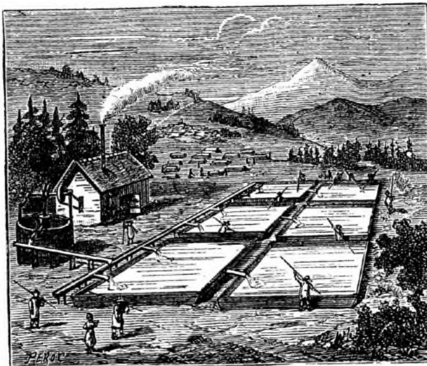
ÉVAPORATION DES EAUX SALÉES. — On trouve dans la terre de grandes masses de sel, tantôt ces masses de sel sont dures comme le roc, et on se sert pour les briser du pic et de la pioche ; tantôt elles sont fondues dans des sources souterraines. Alors on puise l'eau salée avec des pompes et on la fait évaporer dans de larges chaudières ou dans des réservoirs : quand l'eau est évaporée, on retrouve le sel au fond des réservoirs.
